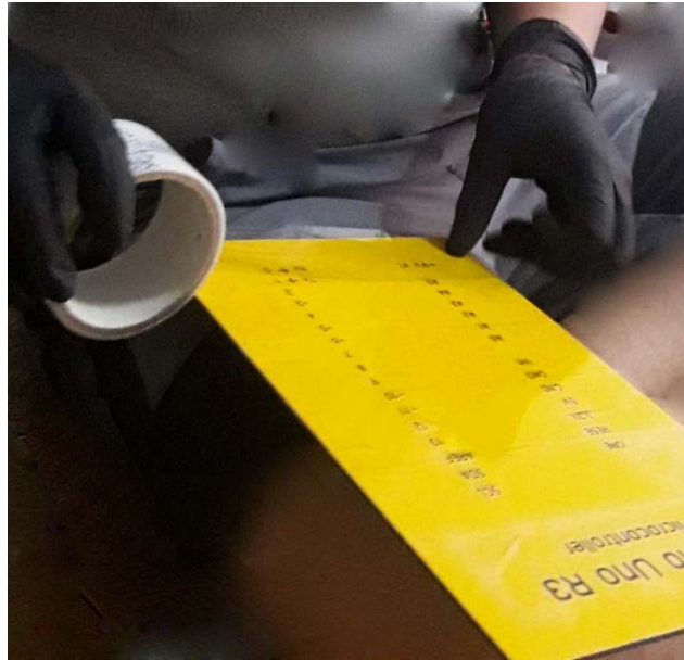
รูปที่ ข.1 ตัดและติดสติกเกอร์ลงบนแผ่นคอมโพสิต
