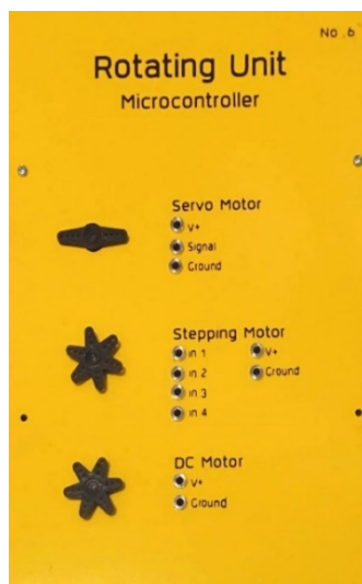
รูปที่ 4.6 ภาพถ่ายชิ้นงานจริงของเซอร์โวมอเตอร์, สเต็ปป์มอเตอร์และมอเตอร์กระแสตรง
