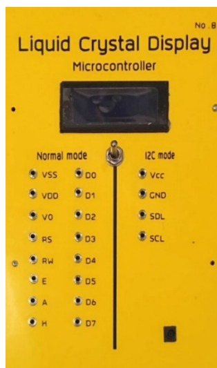
รูปที่ 4.8 ภาพถ่ายชิ้นงานจริงของแผงหน้าจอแอลซีดี ขนาด 20 ตัวอักษร 4 บรรทัด
