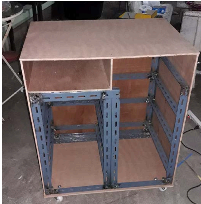
รูปที่ ข.16 ประกอบฉากกล่องเก็บชุดเสาธิต
